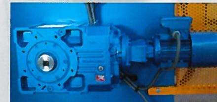
Nouveau groupe de commande à haut rendement permettant de réduire la puissance électrique de 50 %
